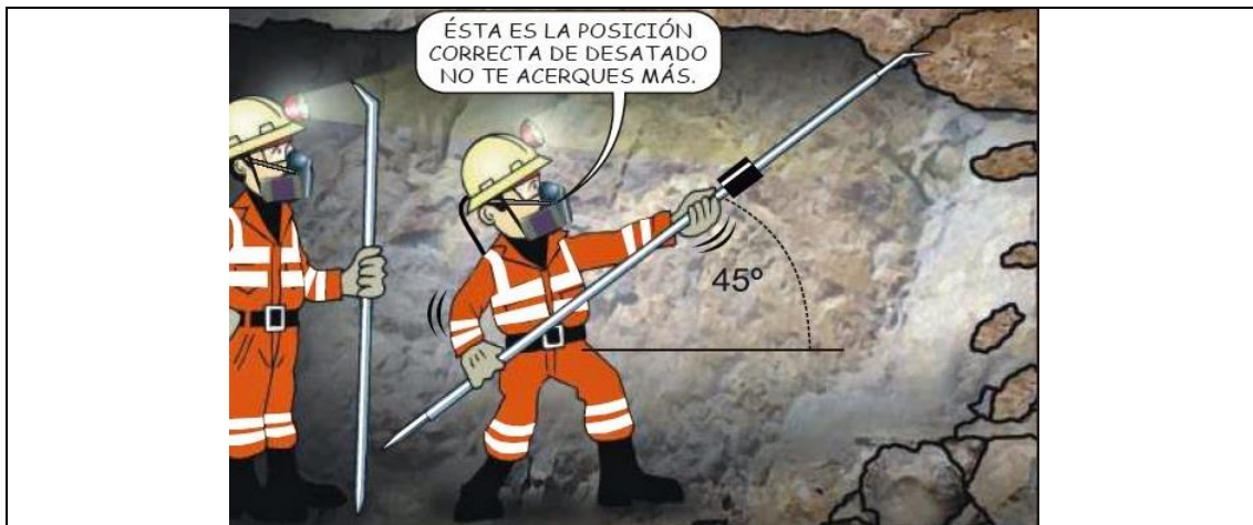
Figura 1.8. Desate de rocas
