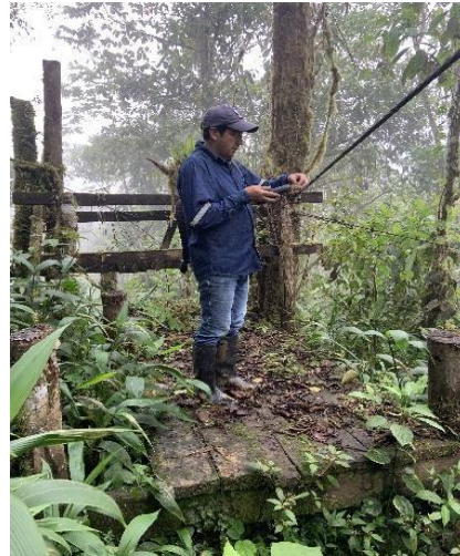
Fotografía 2.2. Tarabita para transporte de material
